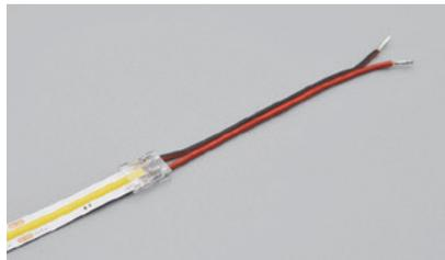
Stellen Sie sicher, dass beide Enden eng miteinander verbunden sind, um sicher zu stellen das die Metallklammer in die richtige Position eingeführt wird. Drücken Sie die Metallklammer mit der entsprechenden Kraft mit einer Zange nach unten. Die Verbindung ist dann hergestellt.
