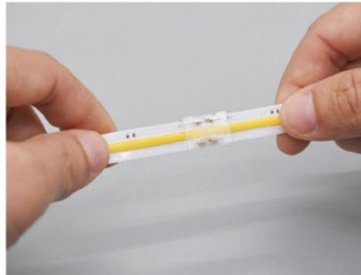
Stellen Sie nach dem Einsetzen der Enden sicher, dass beide Enden der Streifen fest verbunden sind.
