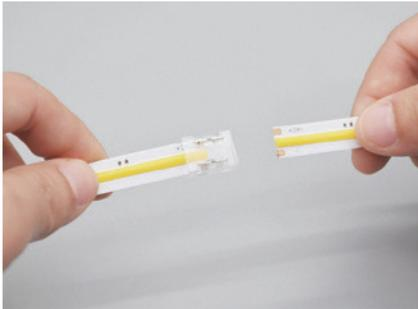
Führen Sie beide Enden der LED-Streifen an die Enden des Direkt-Verbinders ein. Stellen Sie sicher, dass sich die Metallklammer auf derselben Seite befindet wie das Lötpad der LED-Streifen.
