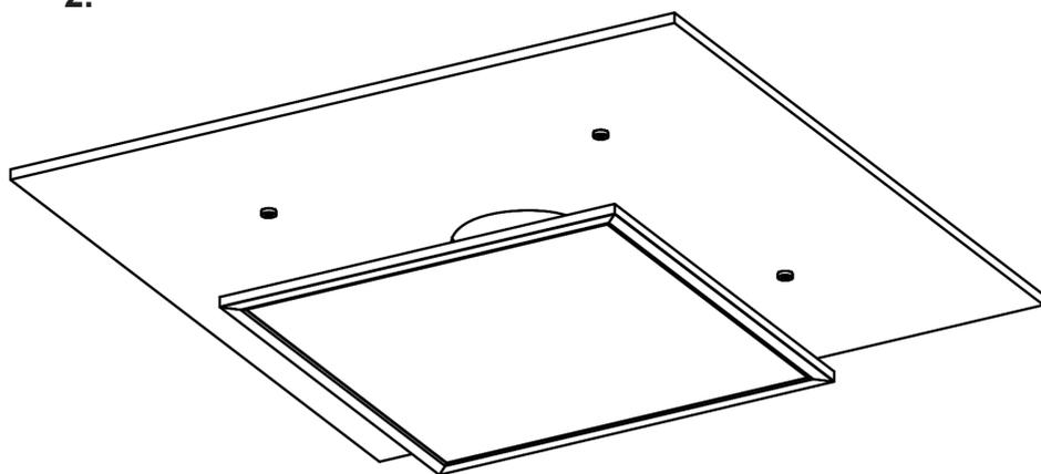
Sie benötigen min 4 Stck oder mehr. Abfangsicherung mit Stahlseil installieren!
